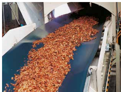
Горизонтальный конвейер с желобчатой лентой. За счет особой структуры и способности к натяжению лента обладает эластичностью в нужном направлении.
