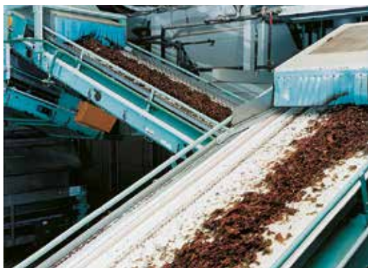
Наклонный конвейер в табачной промышленности. В этой отрасли угол наклона может достигать 22° при использовании конвейерных лент с гладкой поверхностью.
