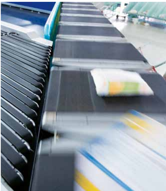
Поперечный сортировщик в распределительном центре. Сильное ускорение требует от поверхности конвейерной ленты максимально высокого коэффициента трения.
