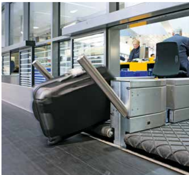
Приемный конвейер в зоне регистрации аэропорта. Плоская поверхность ленты обеспечивает плавную боковую загрузку багажа даже на широкую конвейерную ленту. Огнестойкость материалов – обязательное требование в современных аэропортах.
