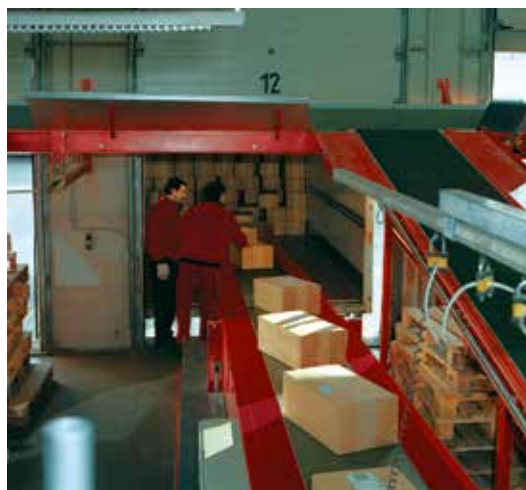
Ленты телескопических конвейеров – на данной иллюстрации используемые для разгрузки грузовика – должны выдерживать встречный изгиб при очень высоких точечных нагрузках.
