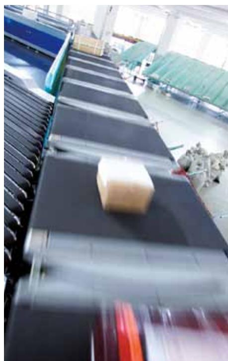
Sortator cu chingi transversale într-un centru de distribuire. Accelerarea puternică necesită coeficiente de frecare extreme ale suprafeței benzii.
