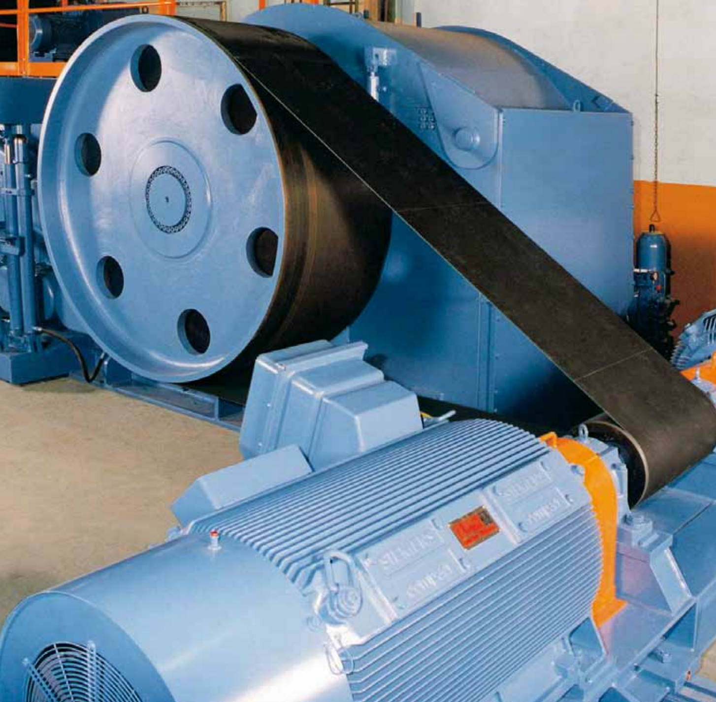
Дробилка (деревообработка), ремень GT 80P, ширина = 1000 мм, мощность привода = 1850 кВт, скорость = 65 м/с
