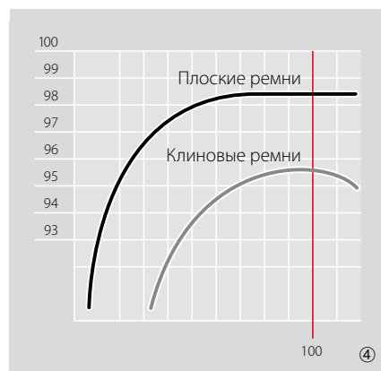
Эффективность плоского ремня (вверху) Эффективность клинового ремня (внизу) Плоские ремни Siegling Extremultus имеют КПД = 98,6%
