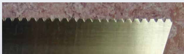
Tanddiepte 2,1 mm, tandafstandsbreedte 2,3 mm, tandbreedte 2,7 mm
