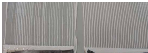
Lijm opgebracht met een vervuilde en met een schone lijmkam
