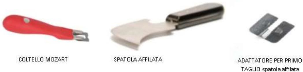
**Nota:** Effettuare la rifinitura finale mentre il cordolo di saldatura e il pavimento sono ancora caldi può provocare la deformazione del cordolo stesso. Ciò potrebbe causare successivi problemi di accumulo di sporco sui giunti o causare danni permanenti alla superficie del pavimento.
