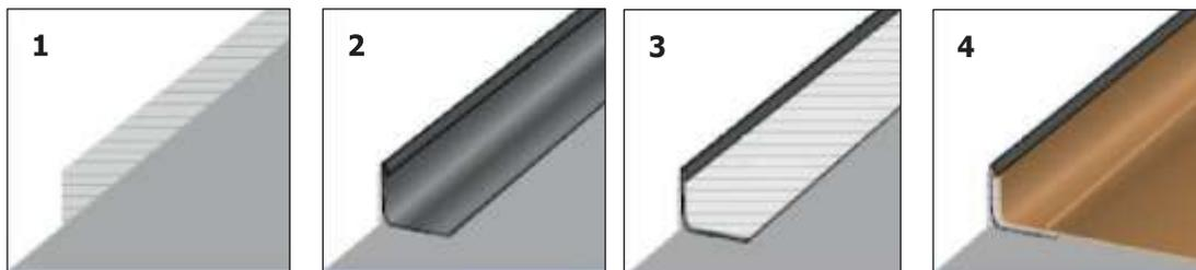
Quando si impiega la sguscia preformata col Surestep Fast Fit, il battiscopa dovrà essere fatto aderire alla parete esclusivamente mediante idoneo sistema di nastro biadesivo resistente ai plastificanti.
