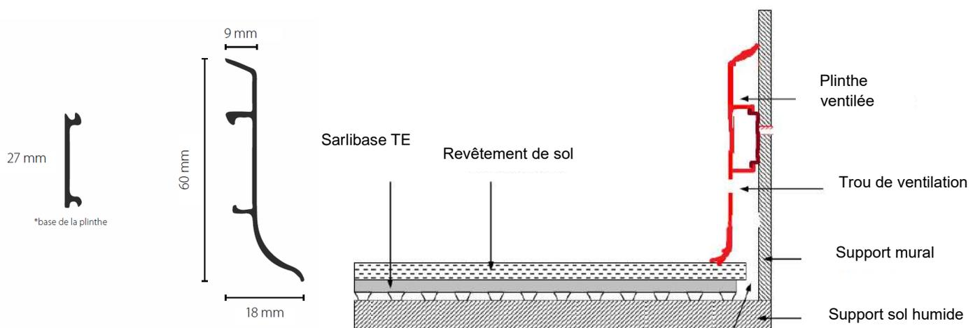
Jeu de ventilation: arrêt de la sous-couche ou du Modul'up TE entre 5 et 10 mm et du revêtement à 5 mm de la paroi verticale
