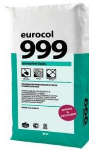
Сухая смесь на цементном вяжущем для финишного выравнивания минеральных поверхностей. Для применения в жилых и общественных помещениях под последующий настил финишного покрытия. Затвердевает без усадки, превосходно растекается, имеет высокую конечную прочность. Подходит для полов с подогревом.
