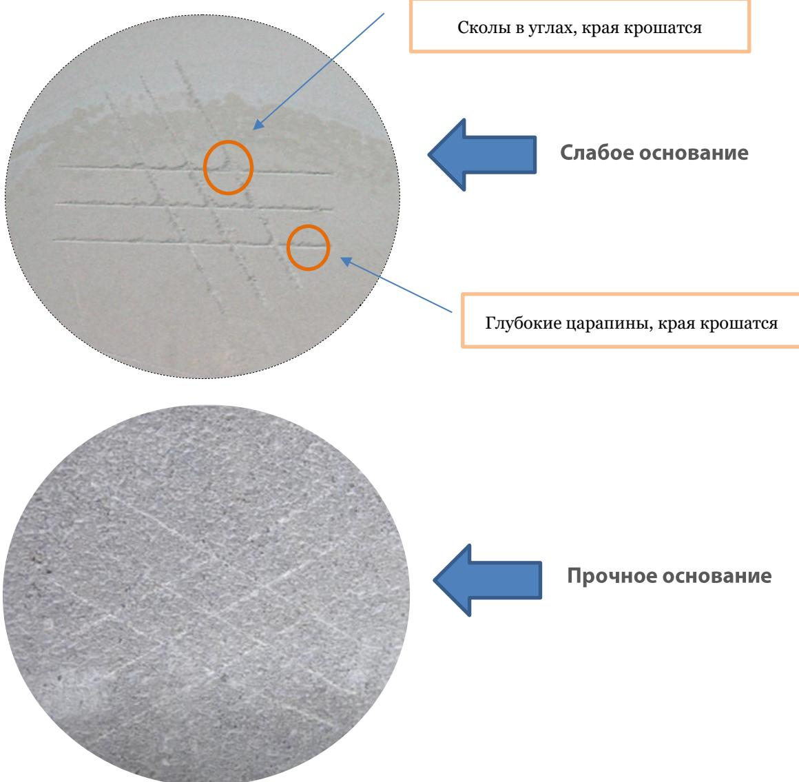
**СТАБИЛЬНОСТЬ И ЦЕЛОСТНОСТЬ основания** также напрямую влияет на качество выравнивающей смеси и ее адгезию с последующим клеевым слоем.
