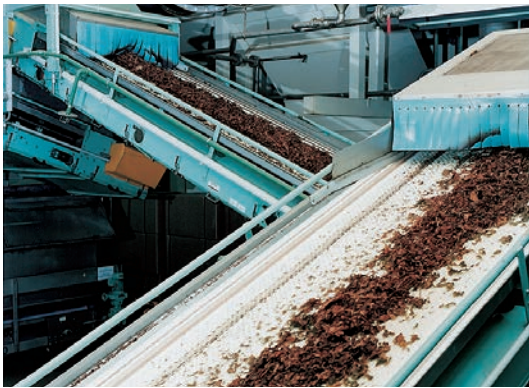
タバコ産業で使用される傾斜コンベアでは、22°までの傾斜搬送が行える平滑タイプのベルトが採用されています。
