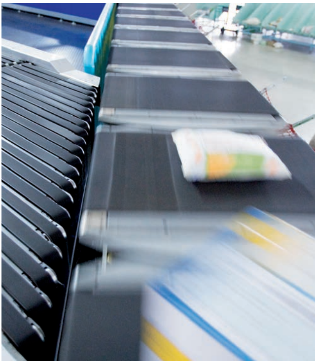
大型物流センターで使用するソータベルトには急加速させるための高摩擦な表面性状が求められます。
