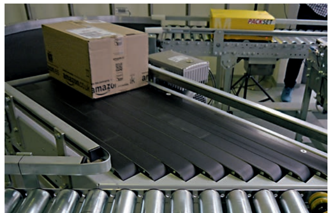
大型物流センターで使用するソータベルトには急加速させるための高摩擦な表面性状が求められます。
