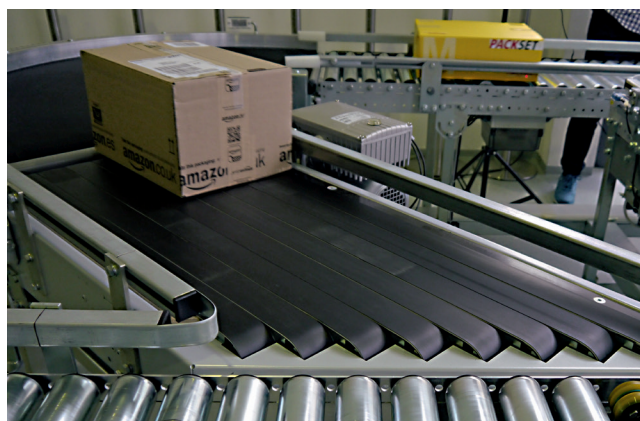
大型物流センターで使用するソータベルトには急加速させるための高摩擦な表面性状が求められます。
