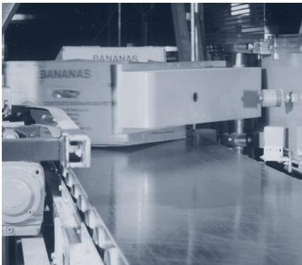
アキュムレーションベルトは、ストッパからの搬送物集荷、または搬送物の搬入 / 払出しに使用されます。特に、高剛性のベルトは、幅広ベルトにおいても、平滑な搬送面を維持することができます。
