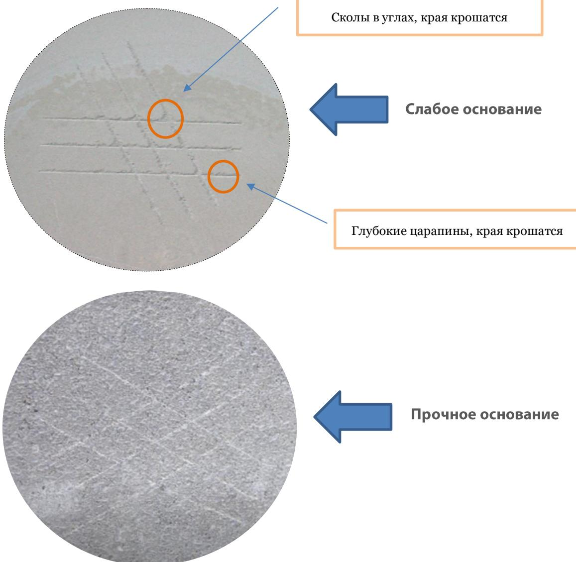
**СТАБИЛЬНОСТЬ И ЦЕЛОСТНОСТЬ основания** также напрямую влияет на качество наливного пола и его адгезию с последующим клеевым слоем.
