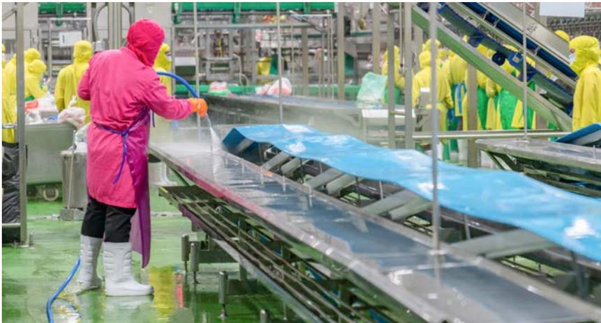
Bei Kunststoff-Modulbändern und elastischen Bandtypen ist eine Anlagenkonstruktion mit Schnellspaneinrichtung und ggf. einer Hebevorrichtung sinnvoll (siehe Abb. 4 und 5). Mit Hilfe solcher Konstruktionen kann das Band einfach angehoben und auch von der Laufseite (Unterseite) gereinigt werden.
