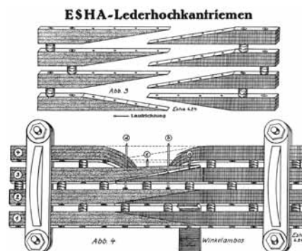
Oben: Aufbau des Chromleder-Hochkantriemens (Darstellung aus dem Jahr 1925).
