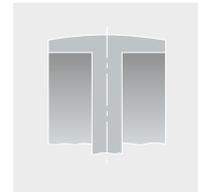
Superficie de deslizamiento forma abombadas
