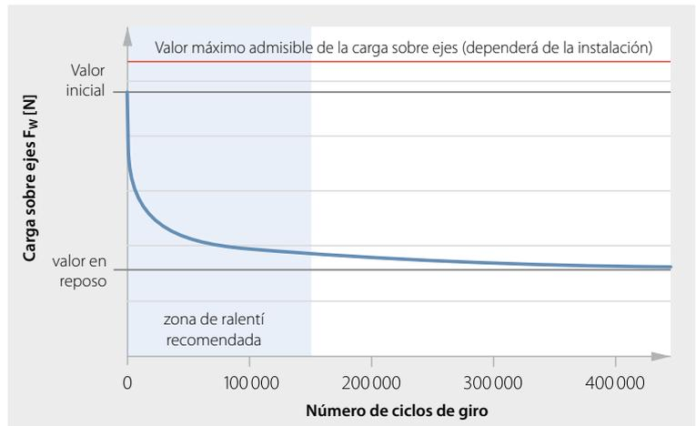
**Observación:** El valor en reposo de la carga sobre ejes sirve como base para el cálculo de la transmisión de potencia de una correa plana. Pero el constructor deberá tener en cuenta el valor inicial mayor de la carga sobre ejes, como mínimo para el dimensionado estático de la carga sobre ejes.
