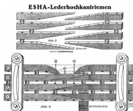
Arriba: Estructura de la correa de transmisión vertical de cuero al cromo (representación del año 1925).
