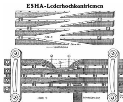
In alto: Struttura di una cinghia verticale in cuoio al cromo (raffigurazione del 1925).
