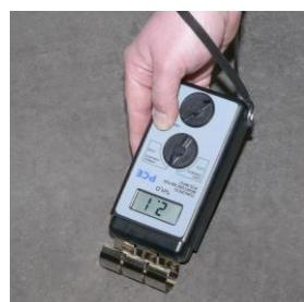
Нарушение требований к влажности основания в дальнейшем часто становится причиной дефектов уже финишных напольных покрытий – вздутия («пузыри» при укладке гибких напольных покрытий), отслоения от основания.
