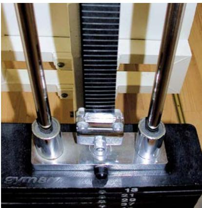
西格林动力传动带（Siegling Powerbelt）可确保重量训练器械的可靠性、安全性和耐用性。小塑料辊轴也可承载超过 100 公斤（221 磅）的重量。
