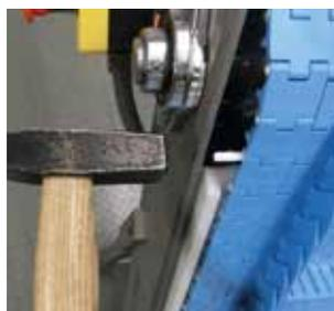
3 Tapoter doucement la tête jusqu'au verrouillage
