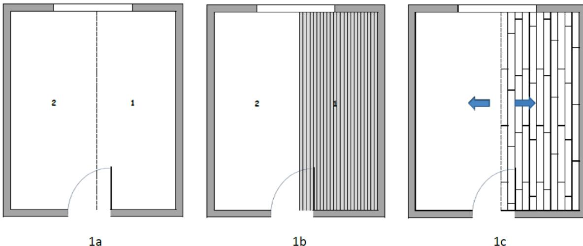
**4.4.2.** V případě lepení dílců ve tvaru čtverců je vhodné na středovou čáru zakreslit ještě jednu kolmou v jejím středu a instalaci zahájit ve středu místnosti. Začněte lepit od zakresleného středu místnosti a pokračujte dle klíče na obrázku 2b. Stejným postupem pokračujete na druhé části místnosti. Přesnost instalace dílců tak máte možnost kontrolovat ve dvou směrech.
