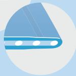
Zudem lässt sich mit der optionalen Bandkantenversiegelung *Smartseal* eine geschlossene Konstruktion realisieren, wodurch das Band rundum vor Kontaminationen geschützt ist.
