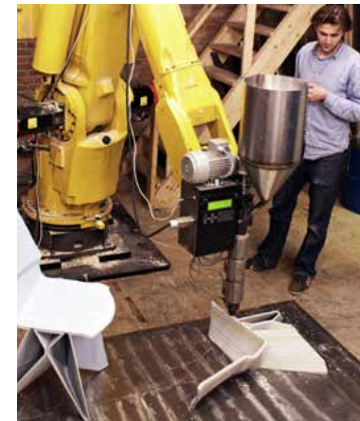
De Endless chair van Dirk Vander Kooij in de maak met behulp van een robot
