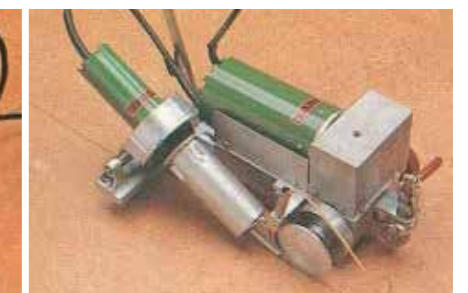
自動溶接機による溶接
