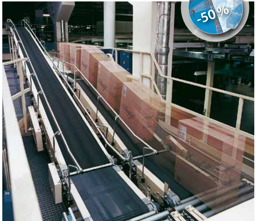
정확하게 계량된 이송물의 정지-이송이 반복되는 구간의 벨트는 급격한 가감속에 적합함이 요구됩니다.
