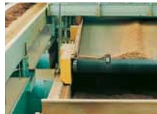
사일로 적재를 위한 셔틀의 수평 이송. 여기서 사용되는 부드러운 표면의 벨트는 최대 20° 경사까지 사용 가능함.
