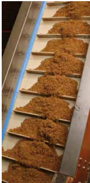
프로파일을 장착한 컨베이어 벨트가 기존 금속 갈퀴를 가진 기기를 대체함으로써 비싼 설치 시간을 줄이고 있습니다.
