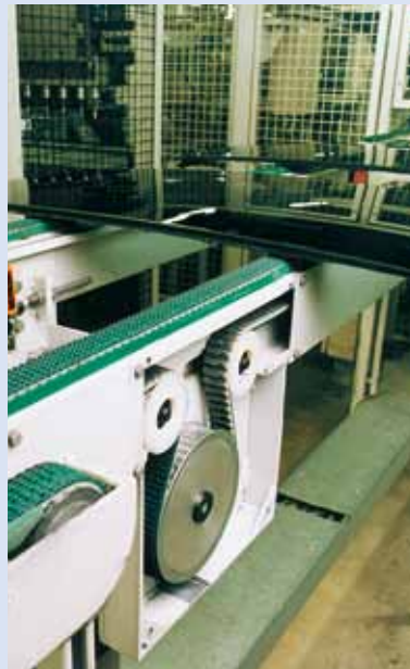
벨트를 동시에 움직여 자동차 창문을 운반함. 타이밍 벨트 후면 커버링이 제품을 부드럽게 다루되 향상된 그립을 제공.
