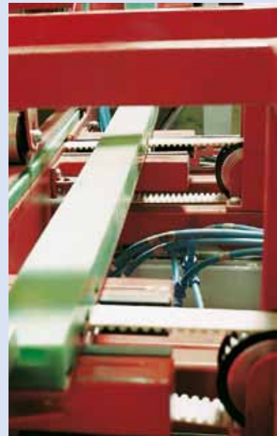
벨트를 동시에 움직여 자동차 창문을 운반함. 타이밍 벨트 후면 커버링이 제품을 부드럽게 다루되 향상된 그립을 제공.
