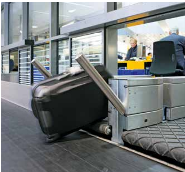
สายพานแบบ collecting ในพื้นที่เช็ควินของสนามบิน ความแบนของสายพานชนิดนี้ทำให้มั่นใจได้ว่าสินค้าจะมีการระบายออกไปยังด้านข้างได้อย่างราบรื่นแม้สายพานจะกว้าง การหน่วงต่อการติดไฟเป็นสิ่งที่ไม่จำเป็นในสนามบินที่มีความทันสมัย
