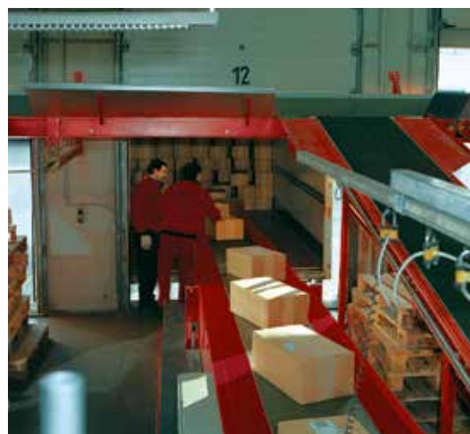
สายพานสำหรับการลำเลียงแบบยึดหด - ที่มีการใช้ในการบรรทุก - จะต้องได้รับการออกแบบให้สามารถเลื่อนไปตามความโค้งของคานาเตอร์และขณะเดียวกันต้องทนต่อน้ำหนักกระแทกสูง
