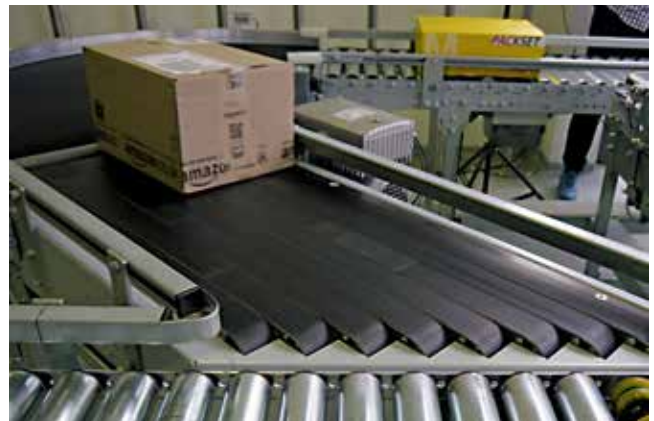
เครื่องจัดเรียงด้านข้างในศูนย์กระจายสินค้า การเร่งความเร็วสูงต้องใช้สายพานที่พื้นผิวมีค่าสัมประสิทธิ์แรงเสียดทานสูง
