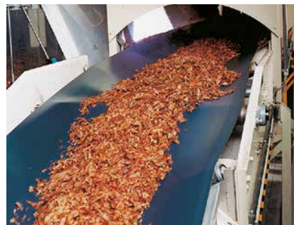
การลำเลียงตามแนวนอนด้วยสายพานที่สามารถทำให้เป็นแนวร่องได้ ส่วนประกอบที่ถูกแรงดึงมีความยืดหยุ่นในทิศทางที่ต้องการ
