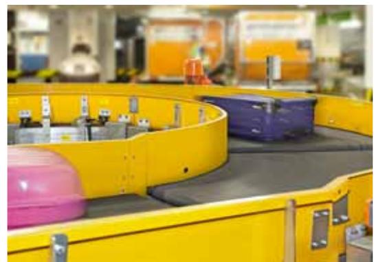
La fabricación de **bandas curvas** a partir de varios segmentos consigue una favorable transmisión de las fuerzas en la banda, de modo que permite transportar de forma fiable incluso productos pesados.
