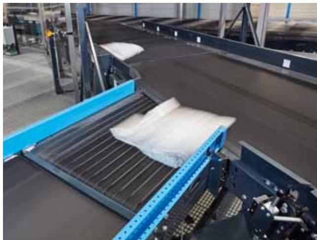
En los **puntos de inversión** las bandas que funcionan en conjunto también se tensan normalmente juntas. Este hecho exige unas tolerancias especialmente reducidas. Los elevados coeficientes de fricción en la cara de transporte garantizan la entrega exacta al clasificador.
