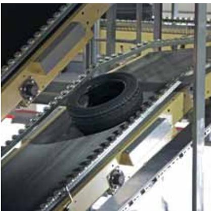
Forbo Siegling ha desarrollado y optimizado numerosos **estructurados superficiales** para las más variadas aplicaciones. Con las bandas estructuradas Siegling Transilon se pueden lograr ángulos de inclinación sin perfiles transversales de hasta 30° de ascensión.
