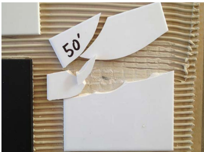
Dezelfde omstandigheden, maar nu mét schuivende beweging. De tegel komt niet gemakkelijk los!
