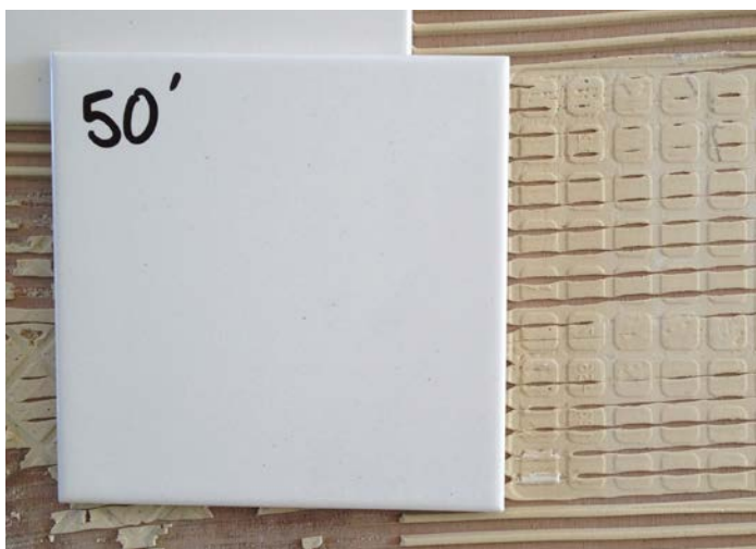
Ondergrond: multiplex, 4x4-veranding. Tegel na 50 minuten ingelegd zonder schuivende beweging, nadat zich een huidje had gevormd. Contactvlak lijkt goed, toch komt de tegel gemakkelijk los.
