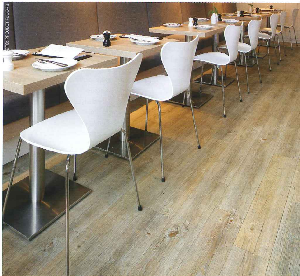
In allen drei Filialen eines Sylter Eiscafés wurden Designbeläge von Project Floors mit Tannenholzdekor verlegt. Wegen der hohen Kundenfrequenz wurde eine Nuttschichtstärke von 0,8 mm ausgewählt.
