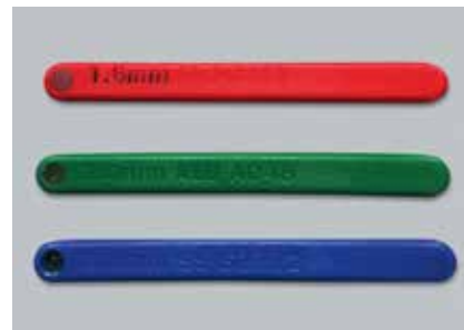
Testobjekte für Metalldetektoren: Kunststoffkörper mit eingebetteter Eisenkugel
