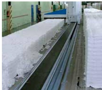
Siebling Transilon belt conveyor dan belt pengolahan mengoptimalkan aliran otomatis material yang ekonomis dan juga memberikan kontribusi yang signifikan untuk mengontrol kualitas dan fleksibilitas dalam proses produksi, berkat:
