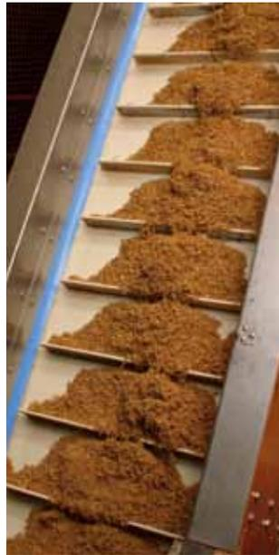
Dalam banyak kasus, belt conveyor yang dilengkapi dengan profil dapat menggantikan peralatan konvensional dengan garpu logam, sehingga mengurangi waktu setup yang berharga.
