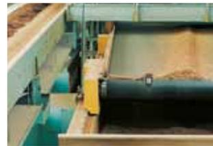
Penghantaran horizontal pada sebuah stasiun untuk pemuatan silo. Jenis belt dengan permukaan yang halus digunakan dalam proses ini, juga dapat digunakan untuk penghantaran menanjak dengan sudut sekitar 20°.
