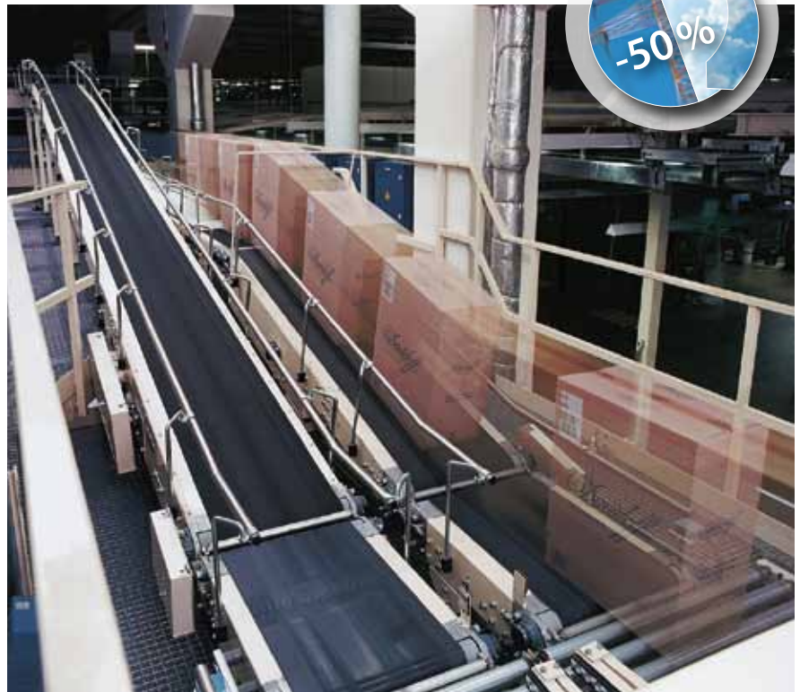
Laju operasi dengan sistem berhenti-bekerja yang tinggi dengan waktu sangat tepat membuat tuntutan untuk penggunaan belt semakin tinggi.
