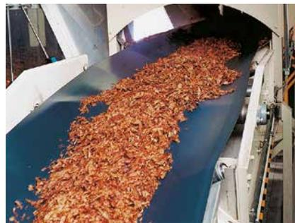
Penghantaran horizontal dengan belt melengkung memanjang. Konstruksi batang tegangan menyediakan fleksibilitas sesuai arah yang diinginkan.
