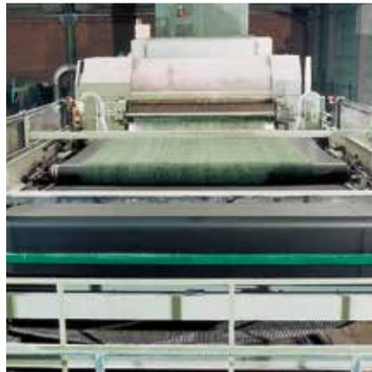
Lipatan silang lapisan jaringan di industri non tenun. Kecepatan produksi tinggi dan percepatan massa sementara jaringan dipandu langsung antara belt menempatkan tuntutan yang sangat tinggi pada belt pemrosesan.
