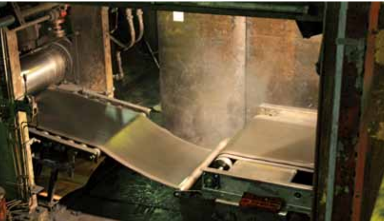
Bagian atas: Setelah berputar, lembaran karet yang panasnya 160°C langsung dialihkan ke belt Siegling Transtex yang sangat tahan terhadap suhu.
