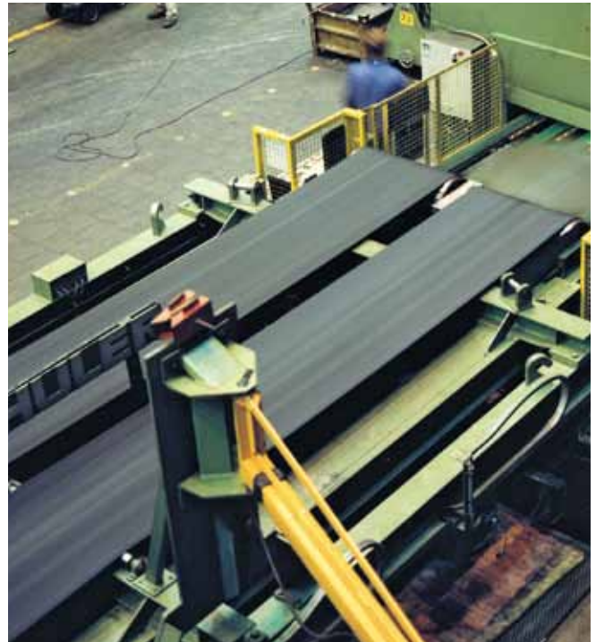
Bagian kanan: Siegling Transtex belt yang secara khusus tahan abrasi dan sayatan menjamin penghantaran handal pada pakan perakitan dan manufaktur lembaran logam.
