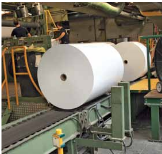
Siegling Transtex dapat dengan mudah menangani beban sebesar 1500 kg tanpa merusak lapisan kertas di luar.
