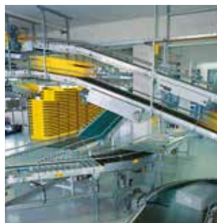
Bezpieczny transport po pochyłościach dzięki wykorzystaniu taśm przenośnikowych z teksturą lub profilami bocznymi.
