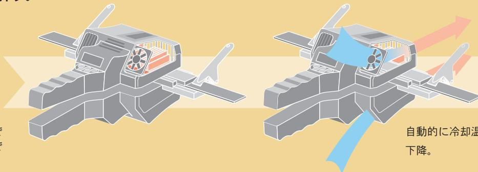
自動的に加熱温度まで上昇。加熱保持時間でベルトを接着。
