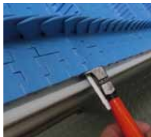
4 Corte el extremo del pasador que sobresale ligeramente por detrás del borde de la banda
