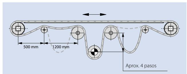
La ubicación de la unidad de accionamiento causa más presión en los ejes situados en los extremos del transportador, puesto que existe una tracción efectiva tanto en el trayecto superior como en el trayecto de retorno en forma de tensión de la banda.
