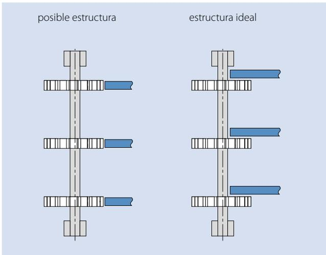
Si se utilizan tiras de desgaste paralelas, recomendamos que las coloque entre los piñones para garantizar el soporte hasta que el piñón entre en funcionamiento y disminuya la distancia.
