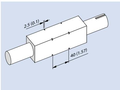
Eje 40 x 40 mm. Fijación del piñón con un anillo de retención de acuerdo con la norma DIN 471 (anillo elástico), d = 56 mm. Las dimensiones detalladas se encuentran en el apéndice en la [página VI-11](#).
