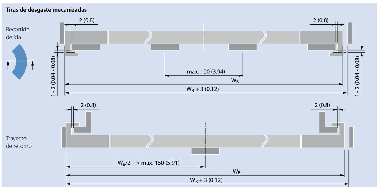
Para las bandas con módulos laterales guiados de forma invertida
