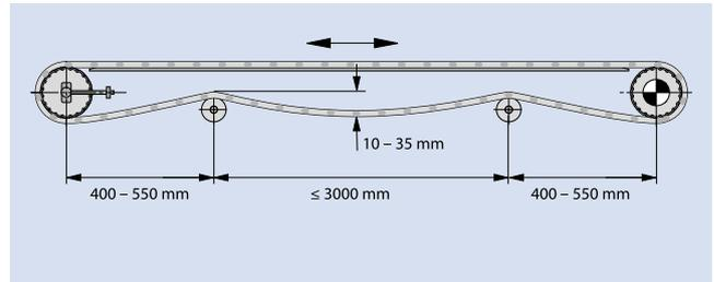
A la hora de tensar la banda, no exceda nunca una elongación de la banda superior al 2%. Si la banda se tensa correctamente, esta configuración de accionamiento puede funcionar bien, pero tenga en cuenta que una tensión más alta reduce la vida útil de la banda.
