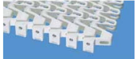
S5 | 45 % apertura | Superficie de rejillas con guías
