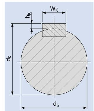
Pueden utilizarse las dimensiones del eje (redondo y cuadrado) de acuerdo con la norma ISO 286-2 h12 (o un grado de tolerancia más cercano, p. ej. h7).
