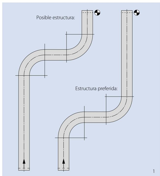
Tenga presente un tramo mínimo en línea recta con una distancia del ancho de banda antes de la curva y dos veces el ancho de banda después de la curva y entre curvas. Esta distancia entre curvas puede reducirse si una curva sigue a otra en la misma dirección (2).
