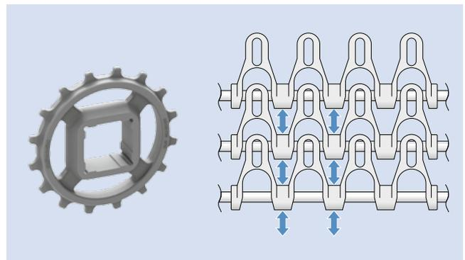
Cuando se usan módulos de lengüeta G o RG, esta lengüeta puede limitar la posición del piñón. Compruebe siempre que el piñón se ha engranado correctamente en la malla de la banda.
