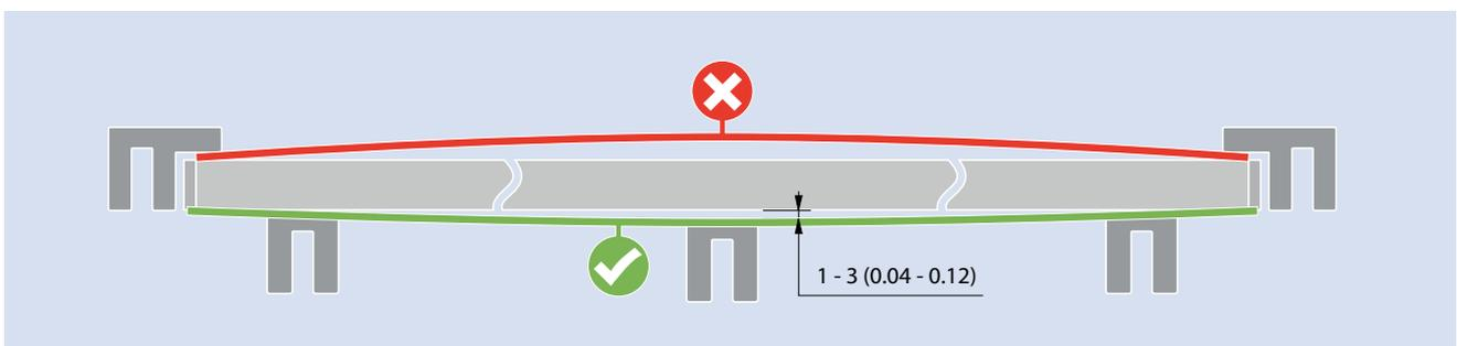
Las series 5 y 9 se montan con pasadores de acero que generan una rigidez superior. Esto reduce, en primer lugar, la tendencia de la banda a levantarse y, en segundo lugar, hace que la banda sea mucho más rígida lateralmente, de
