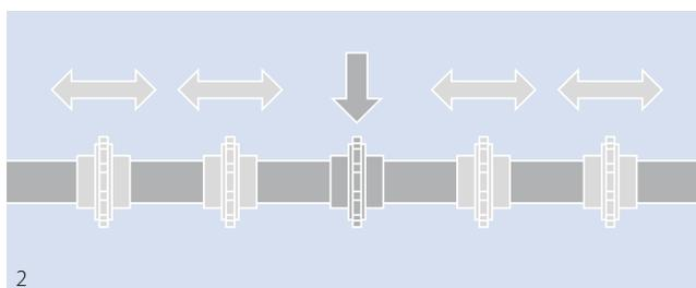
Al fijar el piñón más central, se garantiza una distribución uniforme de la expansión y contracción del ancho de la banda.
