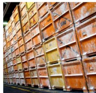
**ÉTAPE 1** L'huile de lin et la résine sont mélangées dans des fûts d'oxydation. Cela donne naissance à un « ciment de linoléum », la base spongieuse du Marmoleum.
