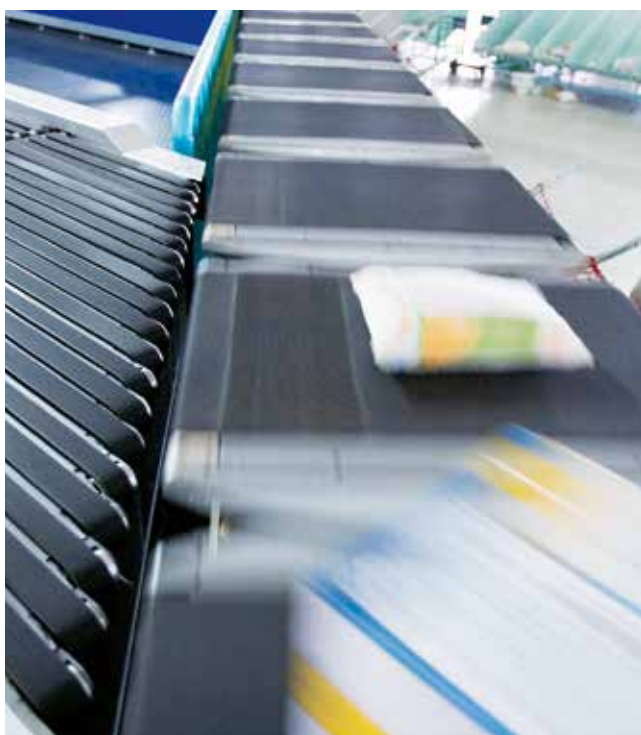
Sortowniki krzyżowe w sortowni. Duże przyspieszenie wymaga ekstremalnie wysokiego współczynnika tarcia powierzchni taśmy.
