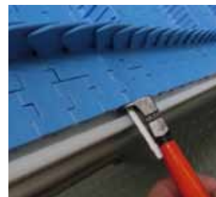
4 Отрежьте выступающий конец стержня немного за краем ленты
