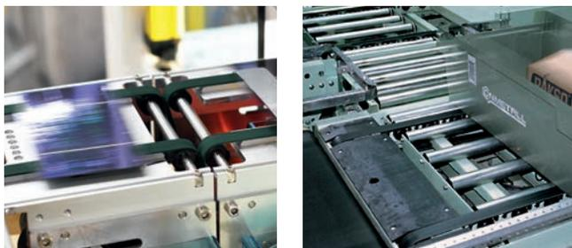
ジークリング エクストレマルタス ドラッグベルトは機械的特性と帯電防止特性を備えるために特別に開発された製品です。電子部品等の高効率かつ安全な搬送およびハンドリングを実現します。
