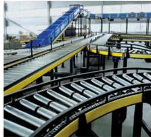
ジークリング エクストレマルタス ライブローラベルトは、流通プロセスにおける高速性と安定性を実現する長寿命な省エネルギー動力伝動ベルトです。
