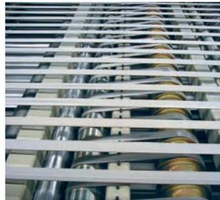
ジークリング エクストレマルタス マシンテープは多くの工業用途に欠かせないマシンエレメントです。ポリエステル帆布、ポリアミドベルト、ポリウレタンの心体を使用し、幅広い用途分野での使用を可能としています。ジークリング エクストレマルタス マシンテープの特長は以下の通りです。
