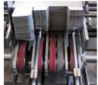
Bei der Herstellung und Verarbeitung von Kartonagen und Wellpappen tragen **Siegling Extremultus Faltschachtelriemen** entscheidend dazu bei, das Qualitäts- und Produktivitätspotenzial der Anlage voll auszuschöpfen. Das Siegling Extremultus Typenprogramm bietet für jede Anwendung den optimalen Riemen mit spezifischem Eigenschaftsprofil:
