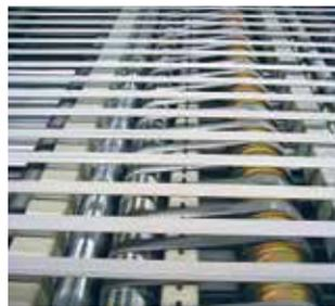
**Siegling Extremultus Maschinenbänder** sind in vielen industriellen Anwendungen unverzichtbare Maschinenelemente. Zuträger aus Polyesterweben, Polyamidband oder Polyurethan qualifizieren sie für unterschiedlichste Einsatzbereiche. Siegling Extremultus Maschinenbänder bieten:
