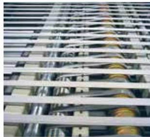
Siegling Extremultus Maschinenbänder sind in vielen industriellen Anwendungen unverzichtbare Maschinenelemente. Zuträger aus Polyestergewebe, Polyamidband oder Polyurethan qualifizieren sie für unterschiedlichste Einsatzbereiche. Siegling Extremultus Maschinenbänder bieten:
