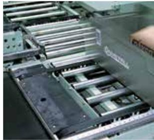
**Siegling Extremultus Doppelgurtriemen** sind Spezialentwicklungen mit besonderen mechanischen und elektrostatischen Eigenschaften, die Transport und Handling z. B. von elektronischen Bauteilen effizienter und sicherer machen:
