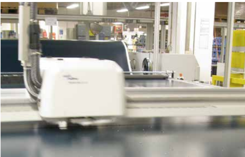
Präzise Herstellung beliebiger Lochbilder auf der CNC-gesteuerten Laser-Schneidanlage.
