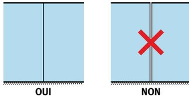
On attendra impérativement 1 à 2 jours minimum après le collage du revêtement pour réaliser la soudure à chaud afin d'éviter la vaporisation de l'eau pouvant rester dans la colle risquant de provoquer des cloques et des décollements sous le revêtement. La réalisation de la soudure se fait en plusieurs étapes :
