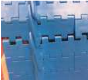
1 移动两个输送带端，直至其正确连接
