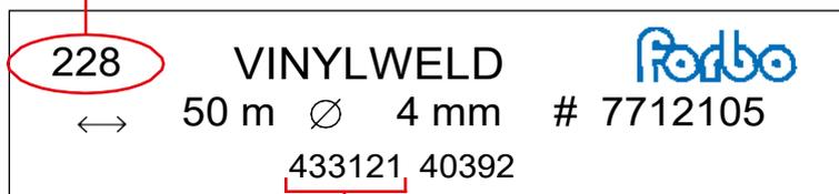
Riferimento commerciale del pavimento in PVC corrispondente a questo cordolo di saldatura
