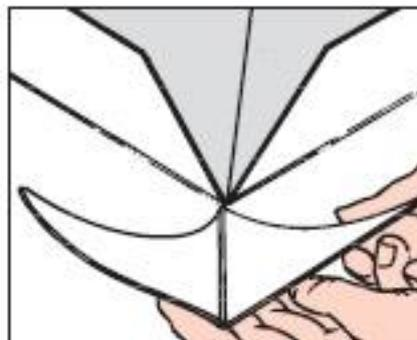
Exécuter les soudures à chaud soit immédiatement si le collage est réalisé à la bande sèche, soit au moins 48 heures après l'encollage à la colle PU du revêtement :
